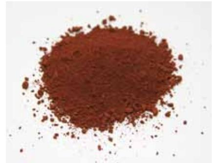
Abbildung: Aluminiumerz - Bauxit
