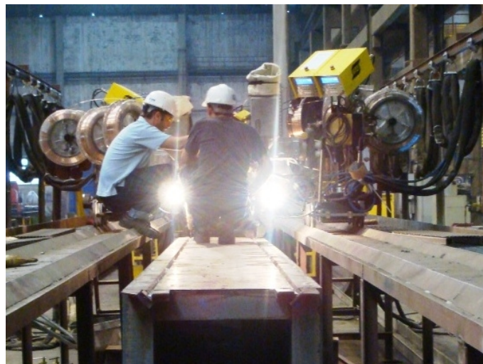
7.kép: Mobil fedettívű Twinarc tandem hegesztőállomás, hegesztőanyag: 2,4 mm-es porbeles huzal
