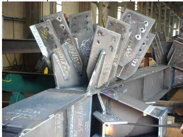
b) Tartóoszlop csatlakozólemezekkel (Shakhtar Stadion)
