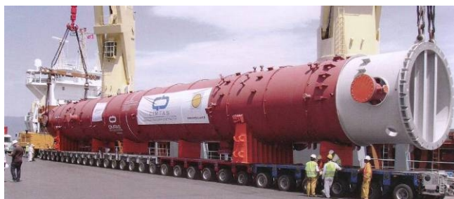
10.kép: Az 500 tonnás (Slug Catcher Surge) tartály hajóra rakodása a gemliki kikötőben
