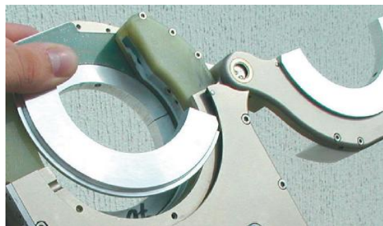
4. ábra Szorítópofa cseréje zárt rendszerű fejen
