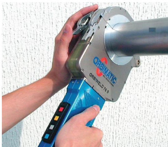
5. ábra Zárt fej rögzítése csövön
