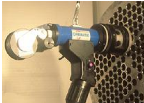
Csőfalhegesztőfej hőcserélő hegesztéséhez előkészítve
