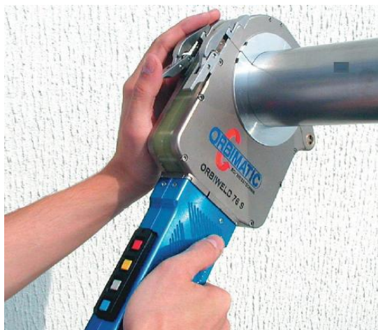
5. ábra Zárt fej rögzítése csövön
