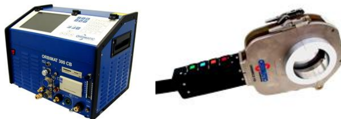
2. ábra Korszerű orbitális hegesztőautomata zárt hegesztőfejjel
