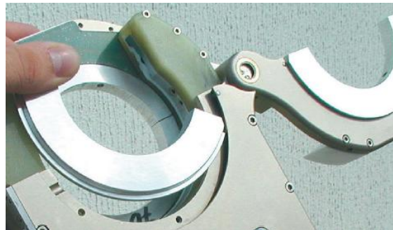
4. ábra Szorítópofa cseréje zárt rendszerű fejen
