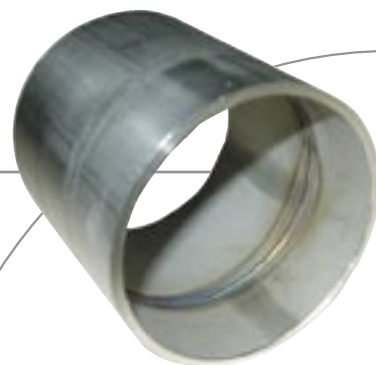
Plazma kulcslyukhegesztés csövön hozaganyag nélkül
