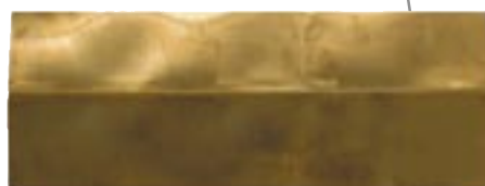
Átlapolt kötés hozaganyag nélkül 1mm-es lemez 2 mm-re
